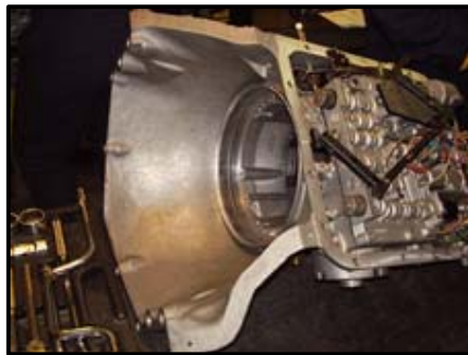
Figura 118. Bomba y cárter retirados
