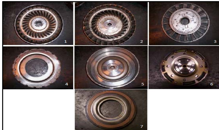
Figura 106. Componentes internos del convertidor de par
