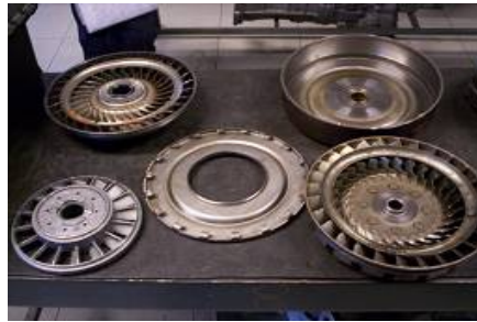
Figura 105. Despiece del convertidor de par
