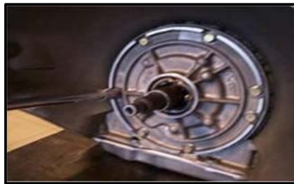
Figura 98. Extracción de pernos de la bomba
