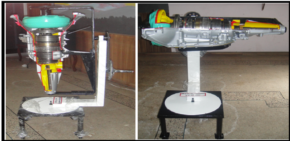
Figura 92. Presentación de la transmisión TH 400 (M40)3 L80.
