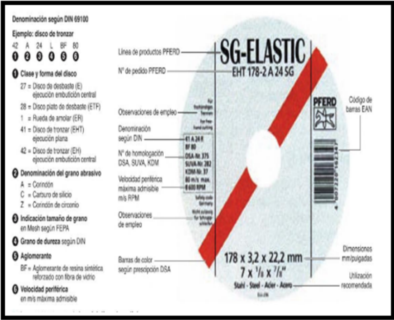
Figura 59. Características del disco radial
