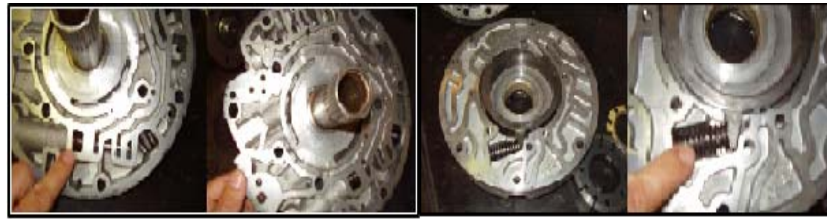
Figura 100. Verificación de rotor paletas y extracción del resorte
