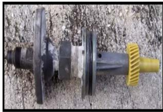
Figura 42. Extracción del velocímetro de la caja de cambios automática TH 400 3L80.
