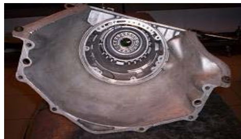
Figura 119. Embragues frontal y de directa retirados de la transmisión
