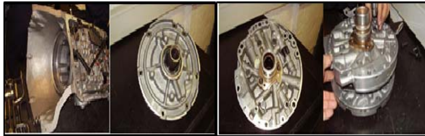
Figura 99. Extracción de la bomba y proceso de desarme
