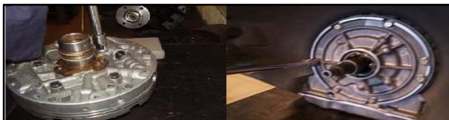
Figura 103. Montaje de la bomba en la transmisión automática
