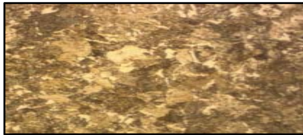
Figura 90. Microestructura de la carcasa de embragues y ejes
