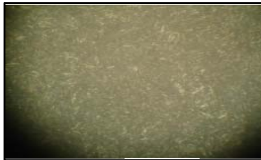
Figura 89. Microestructura del núcleo del resorte
